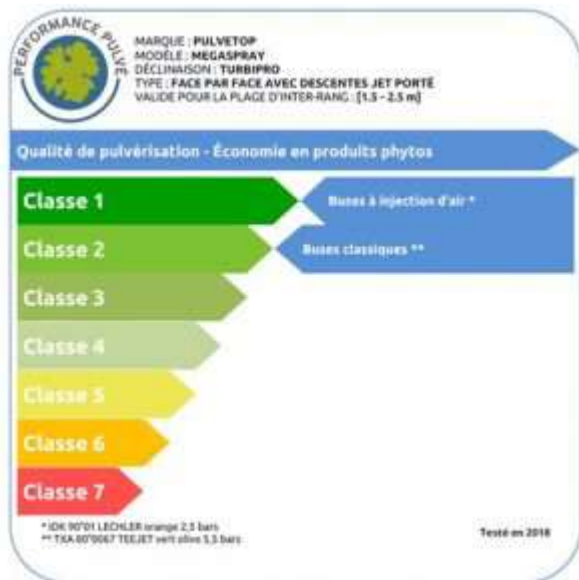
Figure 1 : Spécimen de classification d'un pulvérisateur en fonction de son mode d'utilisation (ou réglage). Ce pulvérisateur spécimen est dans la classe de performance 1 utilisé avec des buses à injection d'air et dans la classe 2 utilisé avec des buses classiques.
