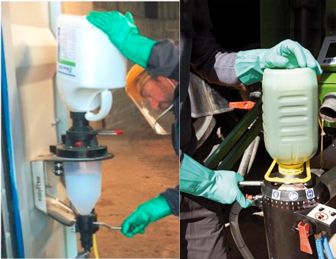
(1) Système STF Easy flow M® - Bidon équipé d'un adaptateur le connecteur équipé d'un bol doseur
